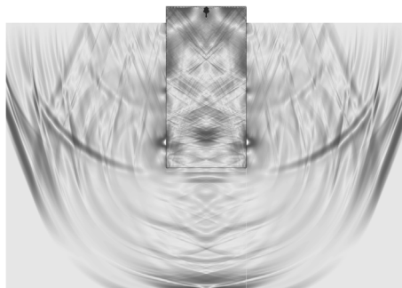
Рис. 3. Волновая картина в воде и айсберге при ударном воздействии на айсберг. Момент времени 0,17 с
